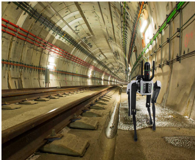
Рисунок 7 – Збір даних тунелю системою BLK ARC
