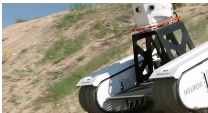
Рисунок 17 – Використання сканеру Pegasus Ultimate на роботизованій платформі Milrem
