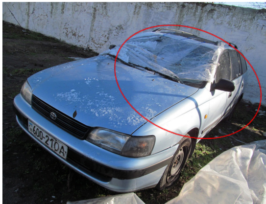
Пошкодження скла вітрового вікна.
