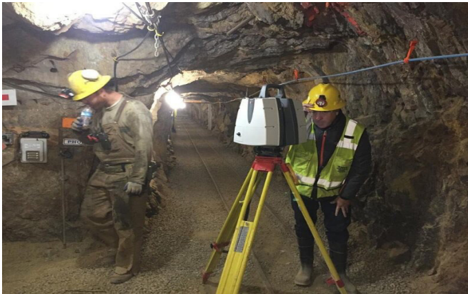
Рисунок 12 – Дослідження підземних споруд за допомогою сканеру Р 50
